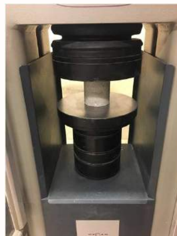
badania laboratoryjne próbek rdzeniowych pobranych z konstrukcji
