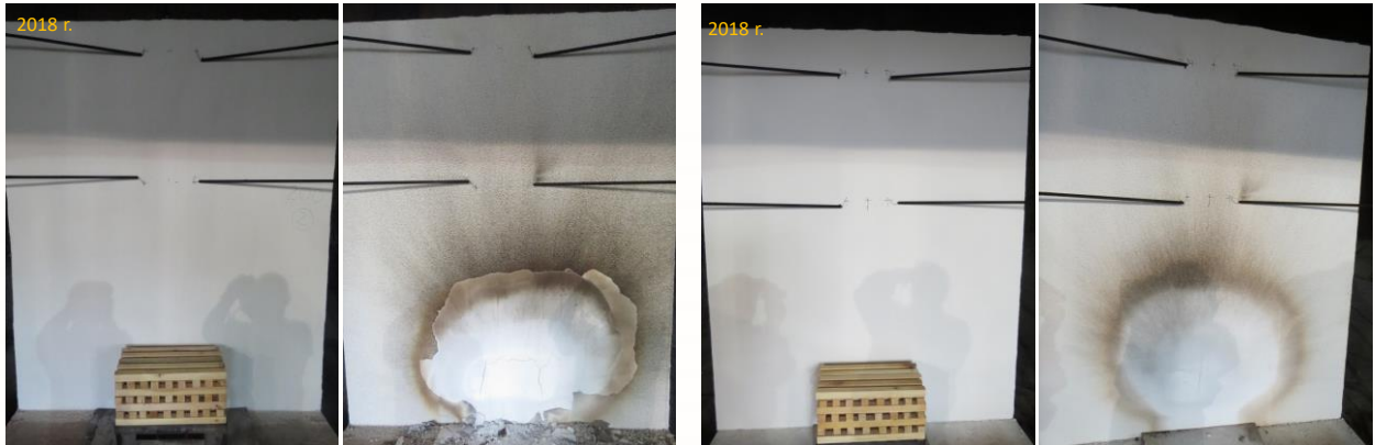
Wełna mineralna o grubości 300 mm i gęstości 90 kg/m 3 Styropian EPS 100 o grubości 500 mm i gęstości 20 kg/m 3
