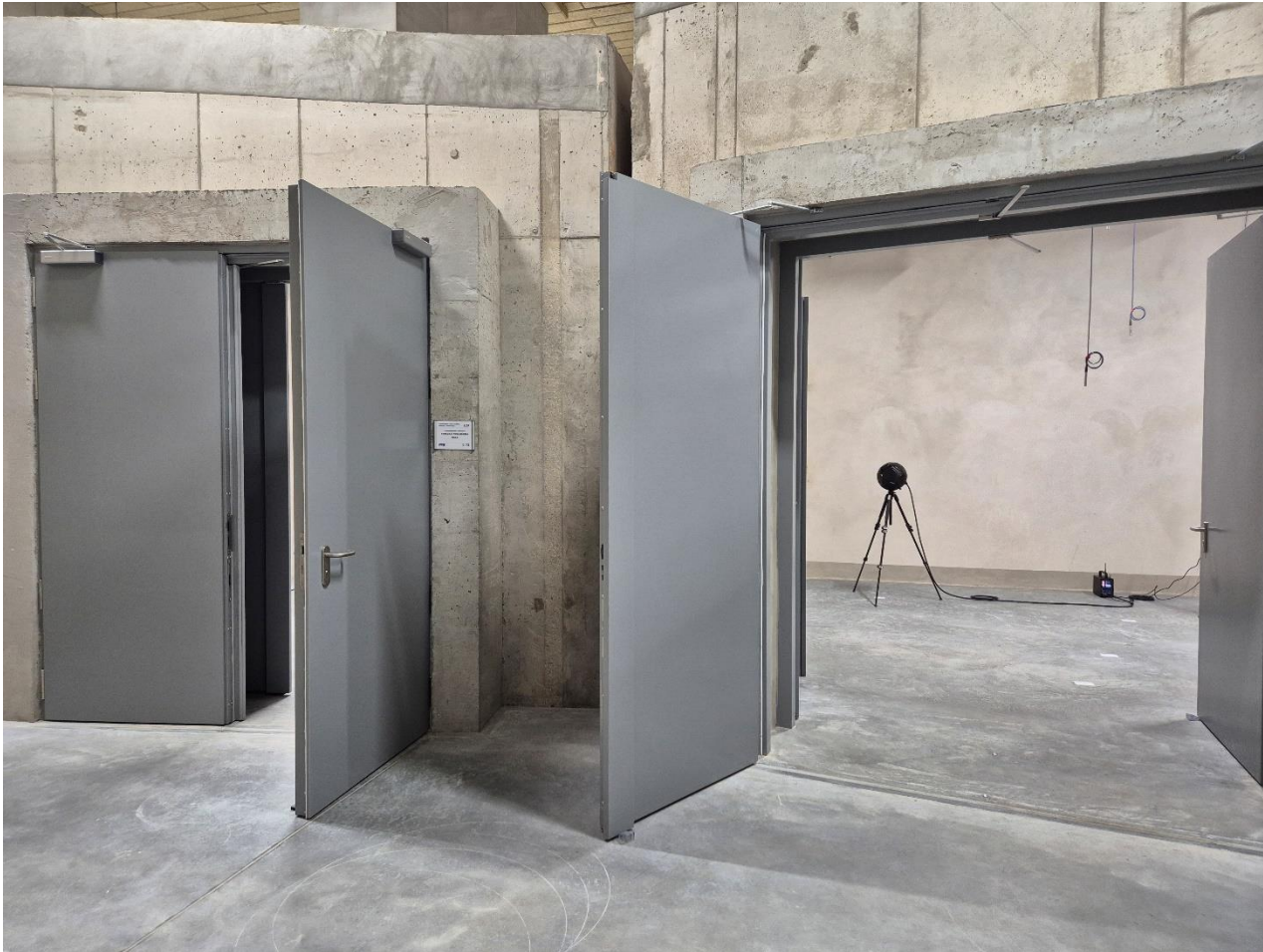
Zestaw dwóch komór pogłosowych o objętości 200 m 3 oraz 100 m 3
